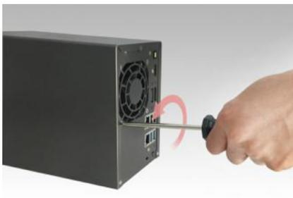
3. 将扣环锁到风扇螺丝孔的位置，依箭头方向锁紧即可。
