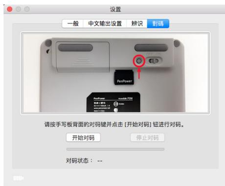
无线小蒙恬无须对码即可使用，只有在更换接收器後才需重新对码。要执行对码的话，请按压手写板背面的对码按钮，此时灯号会开始闪烁，接著点击设置中对码页面的〔开始对码〕，即可完成对码。
